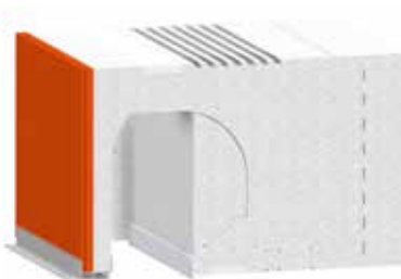
Raffstore Befestigung nach oben
