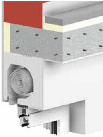
Monolithisch mit Rollladen MS30
